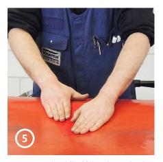
Bringen Sie das selbstklebende Band auf der gereinigten Plane an. Drücken Sie das Klebeband einige Sekunden lang fest auf die Plane.
