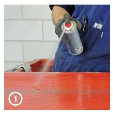
Reinigen Sie die zu beklebende Oberfläche gründlich mit einem fett- und silikonfreien Reinigungsmittel.
