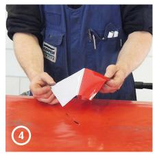
Entfernen Sie die durchsichtige Folie auf der Rückseite des Klebebands.
