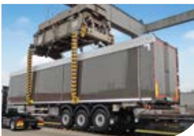
Huckepack vasúti- kombinált fuvarozási kialakítás
