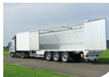
Önhordó szerkezet felépítés
