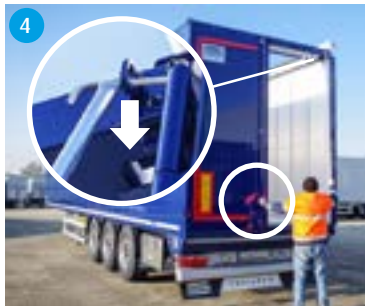
4 Przy użyciu tyczki do plandeki pociągnij w dół blokady górnej belki. Równocześnie otwórz tylne drzwi, pociągając je.
