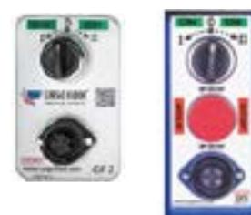
Per evitare operazioni conflittuali con il telecomando CF4, l'interruttore è dotato di ritorno automatico a molla. La posizione I e II, ritorna sempre alla posizione "0". Nella parte anteriore dell'interruttore CF3 c'è un connettore sul quale può essere collegato l'interruttore CF4. L'interruttore CF3 può essere utilizzato in caso di guasto all'interruttore CF4
