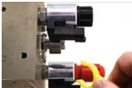
bobina/- perno on -/- off attivato manualmente
