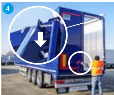
4 Utilizzare l'asta telo per tirare verso il basso i bloccaggi della traversa superiore. Contemporaneamente, aprire il portellone posteriore sinistro.
