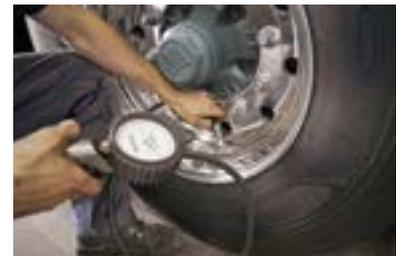
Una corretta pressione di gonfiaggio previene l'usura inutile dei pneumatici e riduce il rischio di scoppio. Mantenendo gli pneumatici alla pressione corretta, risparmierete anche i costi di carburante.
