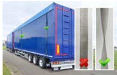
Durante le operazioni di messa in tensione dei nastri tensori quest'ultimi strofinano lungo la parete laterale e il bordo inferiore. Per questo motivo è opportuno utilizzare dei dispositivi di protezione in buono stato. Per prevenire dei danneggiamenti alla vernice è necessario sostituire subito i dispositivi di protezione usurati.
