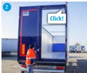
2 Riportare la traversa superiore nella sua posizione di bloccaggio.
