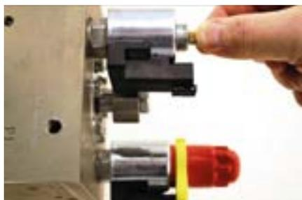
bobina/- perno on -/- off attivato manualmente
