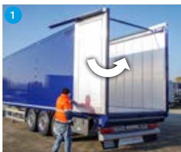
1 Zuerst die linke Hecktür schließen.
