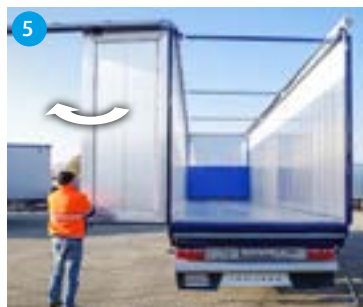
5 Die linke Tür ganz öffnen. Danach ist der Auflieger bereit für den Gebrauch.
