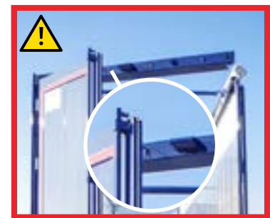
Den Oberbalken nur entriegeln, wenn sich die Verriegelung im 2. Riegel befindet, wie in Schritt 3 beschrieben.
