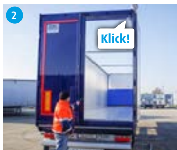
2 Den Oberbalken zurück in seine Verriegelung schwenken.
