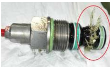
Encrassement du système
