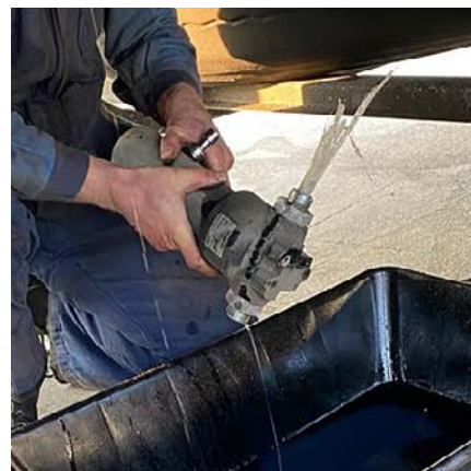
Residui di materiale filtrante nel sistema idraulico
