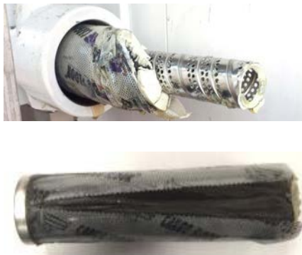
Sur les photos ci-dessus, le boîtier du filtre a explosé.
