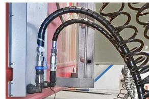
2. Il sistema del ripiano è sovraccarico? Controlla il rilevatore di pressione dell'olio. Una pressione a 225 bar indica un sovraccarico del sistema. Può essere che il piano mobile sia sporco o che il carico rimanga attaccato. In caso di sovraccarico il rimorchio va scaricato (in parte) con una gru mobile.
