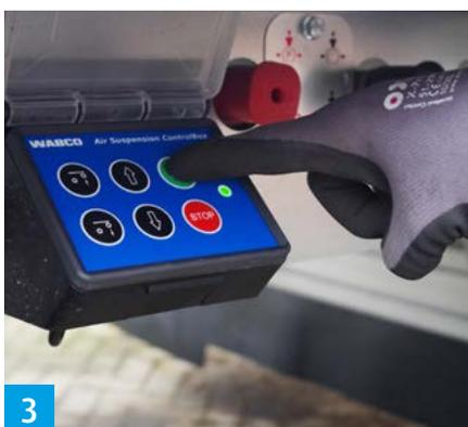
*Nel caso di carico/scarico in una baia di carico, il piano mobile del semirimorchio deve trovarsi alla stessa altezza della baia di carico. Attenzione: riportare sempre l'altezza in posizione di guida dopo aver terminato le operazioni di carico o scarico.*
