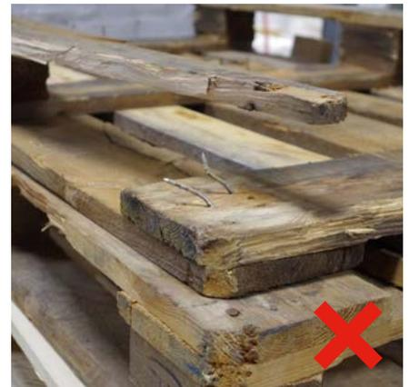
Posizionare sul piano mobile solo pallet piani e in buono stato, senza chiodi sporgenti per evitare che i pallet si blocchino, si inclinino o lascino graffi (profondi) sulle doghe. Se necessario, posizionare una tavola di legno (legno tenero) di circa 300x18x2350mm sotto il pallet.
