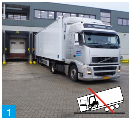
1 La remorque doit être attelée à un véhicule tracteur avant de procéder au chargement/déchargement à l'aide d'un chariot élévateur ou transpalette.
