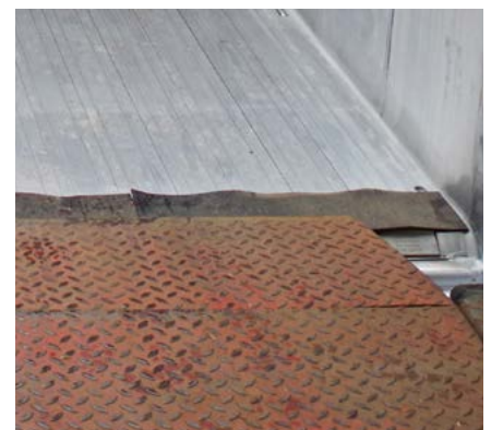
3 En cas de chargement / déchargement à quai, le plancher de la remorque doit se trouver au même niveau que le quai de déchargement. Attention : veuillez à toujours remettre le niveau en position de marche après le chargement ou déchargement.
