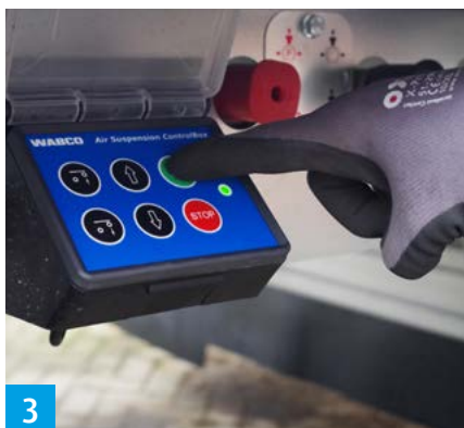
3 Bij belading / lossing aan een laadperron, dient de vloer van de trailer op gelijke hoogte te staan met het laadperron. Let op: zet de hoogte altijd terug op rijstand na het laden of lossen.
