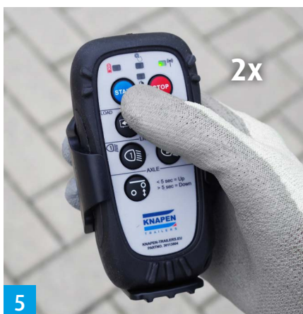
Accendere il telecomando premendo due volte il tasto start
