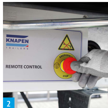
Attivare l'arresto di emergenza in modo che il ricevitore non sia sotto tensione
