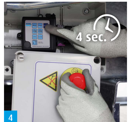
Houdt de ENABLE-knop ingedrukt op de ontvanger en deactiveer de noodstop. Laat de ENABLE knop na 4 seconden los.
