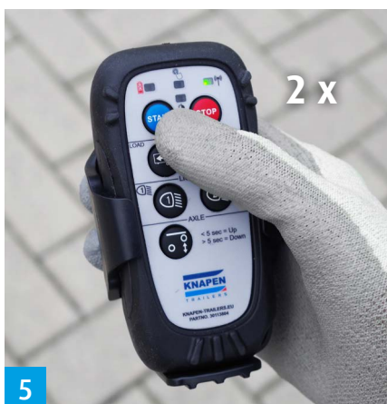
5 Fernbedienung durch 2-maliges Drücken auf „Start“ einschalten.
