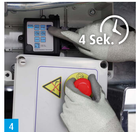
4 ENABLE-Knopf auf dem Empfänger gedrückt halten und Not-Aus deaktivieren. ENABLE-Knopf nach 4 Sekunden auslassen.
