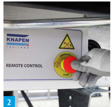
2 Not-Aus aktivieren, sodass der Empfänger keinen Strom bekommt.
