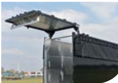
Hydraulische achterklep (optioneel met geïntegreerde deuren)
