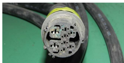
Folge: Durch eine schlechte Abdichtung der Kabelverschraubung kann Feuchtigkeit in die Kabel eindringen und Korrosion verursachen.
