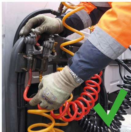
Tip: Die Luftleitungen der Zugmaschine nach dem Abkuppeln aufgehängen
