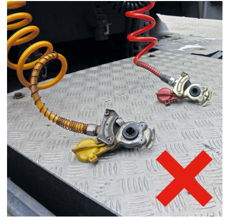
Tip: Die Luftleitungen der Zugmaschine nach dem Abkuppeln aufgehängen
