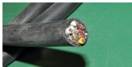
Achten Sie darauf, dass das Kabel gut in der Kabelverschraubung steckt, um Korrosion zu vermeiden.
