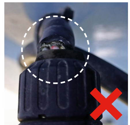
Achten Sie darauf, dass das Kabel gut in der Kabelverschraubung steckt, um Korrosion zu vermeiden.
