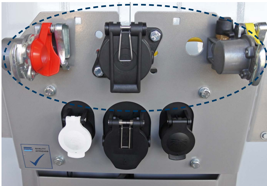
De aansluitingen t.b.v. de EBS-modulator bevinden zich op het kopschot van uw trailer
