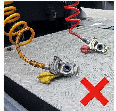
Tip: Hang de luchtleidingen van de truck altijd op na het afkoppelen
