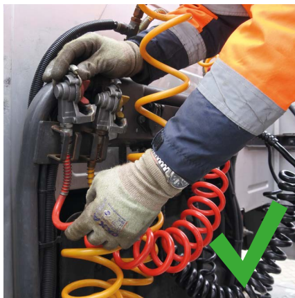
Tip: Hang de luchtleidingen van de truck altijd op na het afkoppelen
