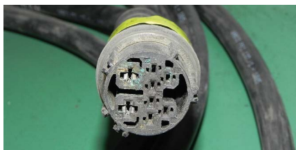
Gevolg: door een slechte afdichting van de wartel kan er vocht in de kabels kruipen met corrosie tot gevolg
