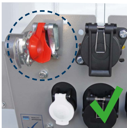
Chiudete sempre le testine affinché non si depositi sporcizia nelle condutture
