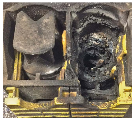
Conseguenza: a causa di umidità/cattiva connessione le connessioni del modulatore EBS possono prendere fuoco
