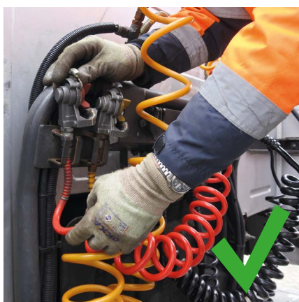
Suggerimento: Inoltre, è importante che i condotti dell'aria dell'autoarticolato vengano appesi dopo lo sganciamento.
