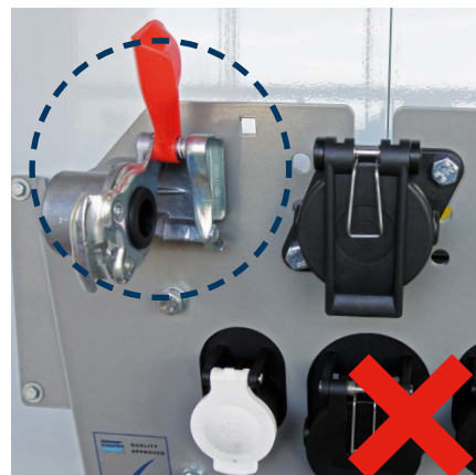
Chiudete sempre le testine affinché non si depositi sporcizia nelle condutture
