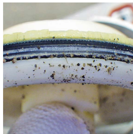
Conseguenza: A causa della sporcizia nei condotti dell'aria si forma sporcizia all'interno del modulatore EBS.
