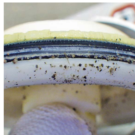
Conséquence : La pénétration de saletés dans les conduites d'air génère un encrassement à l'intérieur du modulateur EBS.
