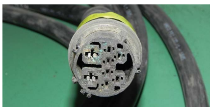
Conséquence : en raison d'une mauvaise étanchéité du presse-étoupe l'eau peut pénétrer dans les câbles et provoquer une corrosion.
