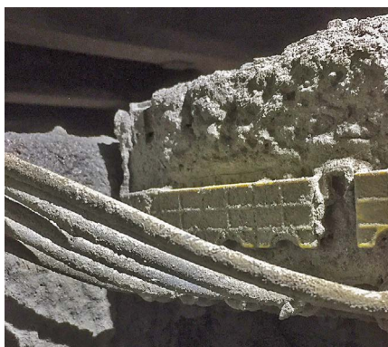
Nettoyez régulièrement le modulateur EBS et vérifiez le câblage.
