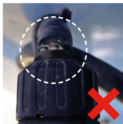
Assurez-vous que le câble est correctement inséré dans le presse-étoupe pour éviter la corrosion
