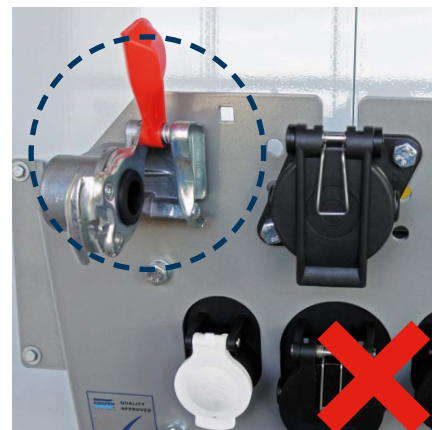
Toujours fermer les coupleurs rapides pour éviter qu'aucune saleté ne pénètre dans les conduites.
