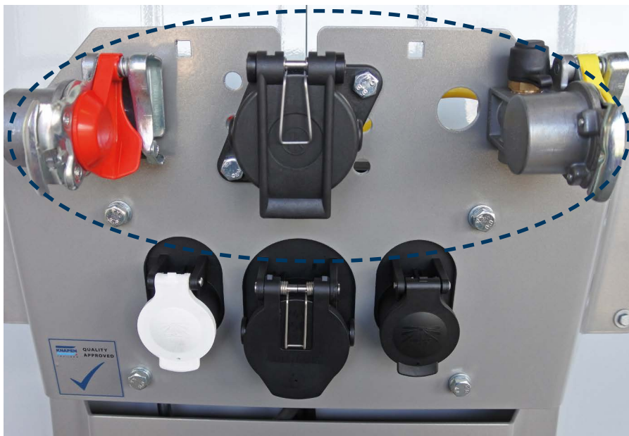
Les raccordements du modulateur EBS se situent sur la ridelle frontale de votre semi-remorque
