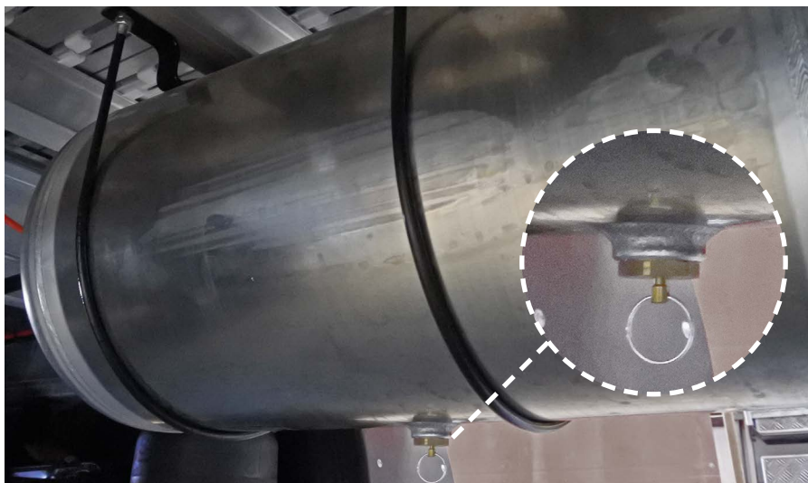
Sous le réservoir d'air de votre semi-remorque se trouve un anneau vous permettant de contrôler la qualité de l'air du système d'air comprimé.
