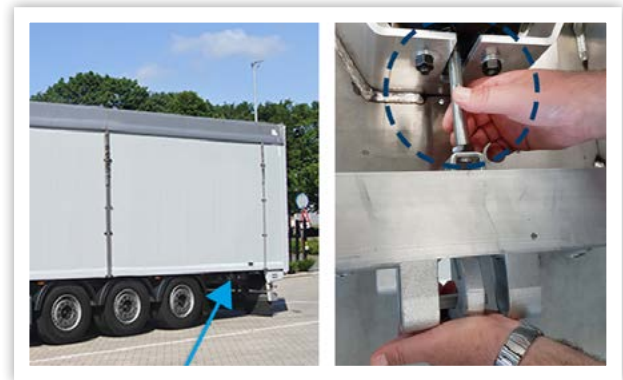
Durch eine Drehbewegung wird die Stellung der pneumatischen Hecktürverriegelung geändert.
