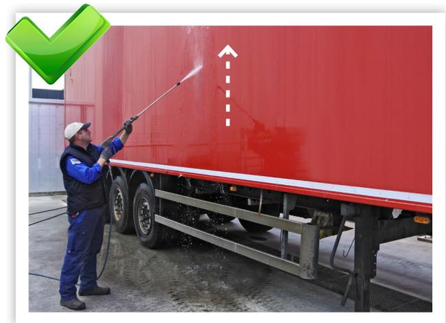
4. Utilizzare acqua ad una pressione di massimo 60 bar (870 Psi). In caso contrario, l'eccessiva pressione dell'acqua per centimetro quadrato danneggerebbe la vernice.
