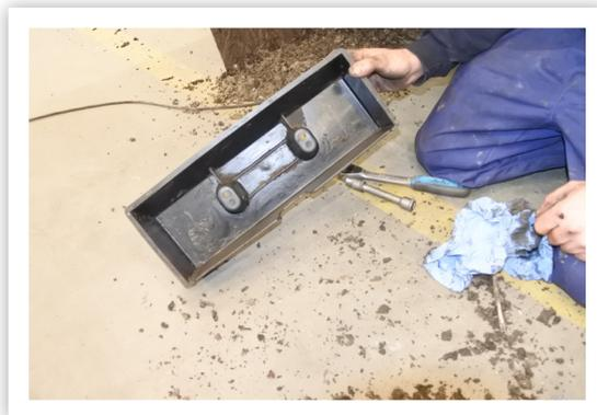
4. Drehen Sie den Stecker aus dem Konnektor und säubern Sie den Stecker, den Konnektor und die Rückplatte sorgfältig.
