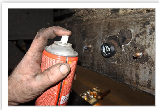
6. Schließen Sie den Stecker wieder an und montieren Sie die Abdeckkappe. Wiederholen Sie diesen Prozess bei der Abdeckkappe an der anderen Seite des Trailers.
