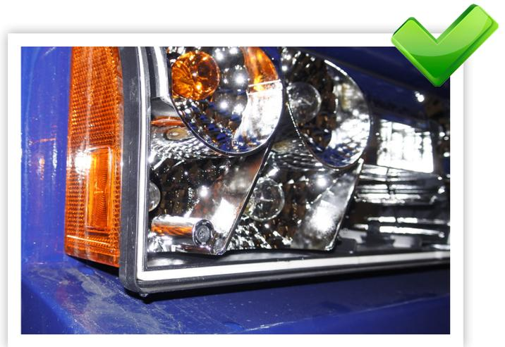
Schritt 2: Setzen Sie die Lampenabdeckung wieder ein. Sorgen Sie dafür, dass diese richtig abschließt.
